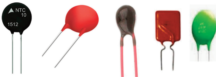
Slika 2.7 Različiti oblici termistora
